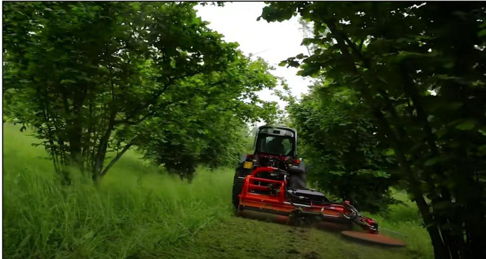
Figure 49 Exemple de broyeur avec satellite latéral (Belingard SARL)
